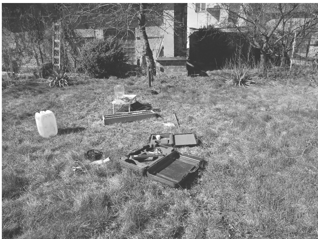
Obr. 2: Probíhající vsakovací zkouška s konstantním spádem ve vrtu S2/VSAK1. Pohled od východu.
